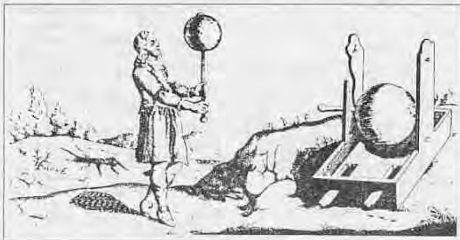
6. ábra. Guericke elektromozó „gépe” és a megdörzsölt kengőmb vonzó hatása. 1672-ben megjelent „Experimenta nova” könyvében így mutatta be a sztatikus jelenségeket: a megdörzsölt kengőmb tollpihét vonz vagy taszít. Elektromozó gépét a féltengely körül forgatott kengőmb alkotta.
