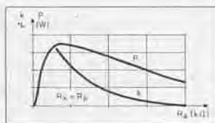
4. ábra. Trióda kimenőteljesítménye és torzítása az illesztés függvényében
