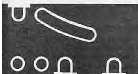
29. ábra. Szétosztott, kétkimenetű, véglezáros iránycsatoló fólia-rajza
