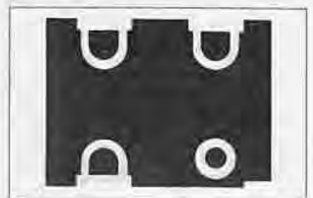
6. ábra. A leágazó (iránycsatoló) nyákrajza
