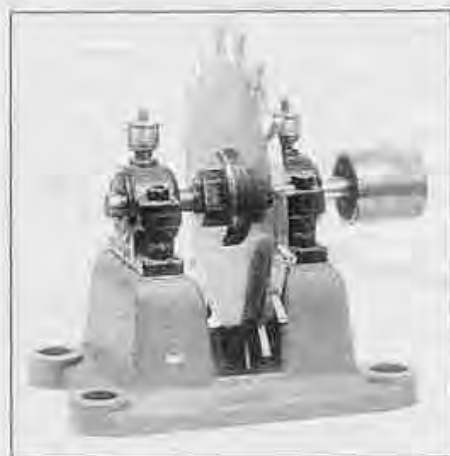
Marconi szikraszaggató szerkezete az oltotszikrás adókhöz (1907)
