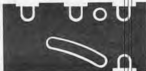
25. ábra. Szétosztott, kétkimenetű leágazó fóliarajza
