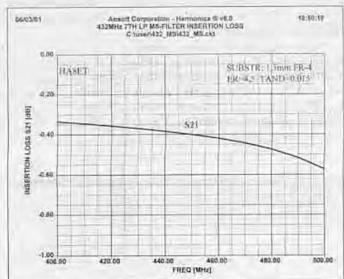
11. ábra. A microstrip szűrő beiktatási csillapítása 400 és 500 MHz között szimulálva
